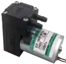
Bis zu 180 ml/min Förderrate bei einem maximalen Druck von bis zu 1 bar und kompakter Bauweise. Hochbeständige Membran aus PTFE und Ventile aus FFKM.
