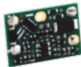
Wird beispielsweise ein Ventil mit 24 VDC geschaltet, kann die Spannung unter normalen Bedingungen auf 10 VDC zum Halten dieser Position reduziert werden. Durch diese Schaltung ergeben sich diverse Vorteile, wie beispielsweise ein deutlich geringerer Stromverbrauch, eine deutlich geringere Erwärmung der Magnetspule, Optimierung der Reaktionszeit, erhöhter Arbeitsdruck, Minimierung von Baugrößen, usw..
