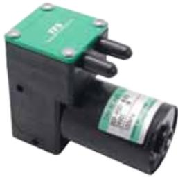
Bis zu 400 ml/min Förderrate bei einem maximalen Druck von bis zu 1 bar. Hochbeständige PTFE Membran und Ventile aus FFKM.
