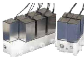
Dieses Manifold besteht aus einzelnen Basisblöcken mit je zwei 2/2-Wege-Ventilen der XTA/WTA-Serie. Es können bis zu 6 Blöcke verbunden werden, wodurch Manifoldlösungen mit bis zu 12 Stationen einfach realisiert werden können.
