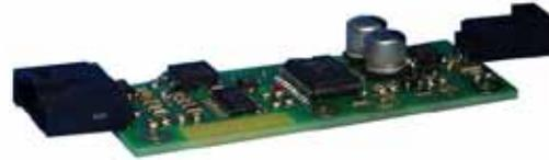
Die ZC1 Elektronik hat lediglich einen Kanal und ist als OEM Platine für die Integration in eigene Geräte gedacht. Sie kann über eine RS-232 Schnittstelle parametrisiert und gesteuert werden.
