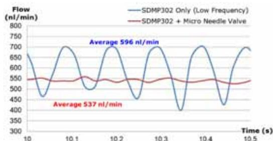
Setzt man ein Mikro-Nadelventil der MNV Serie bei dem Ausgang einer Piezopumpe oder einer Schlauchpumpe ein, wird die Pulsation signifikant gedämpft. Wie in der abgebildeten Grafik beispielhaft zu sehen, wird die Pulsation einer SDMP302 Piezopumpe fast vollständig unterdrückt.
